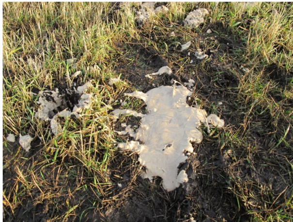
Figur 2-1 Øverst eksempel på brat overgang fra muldjord til kalk, nederst eksempel på opgravet, blød og vandmættet kalk.
