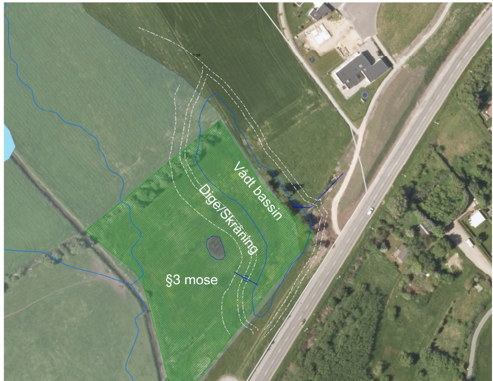
Figur 3-1 Udformning og placering af bassin til forsinkelse og tilbageholdelse af sedimenter og forurening fra regnvand.
