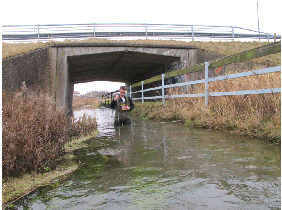
Figur 2-7 Udførelse af vandføringsmåling ved Over Engen 19. februar 2014
